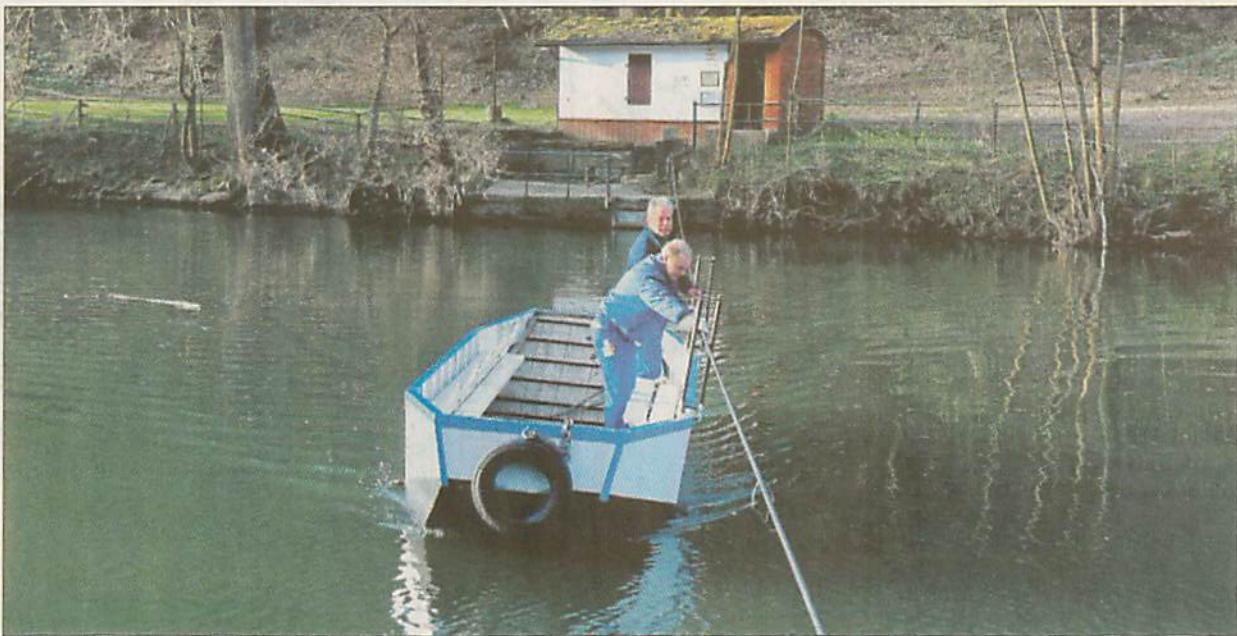
Erste Fahrt am Donnerstagmorgen: Mitarbeiter des Weilburger Bauhofs haben das Boot zu Wasser gelassen und das Drahtseil gespannt, an dem das Rollschiff sicher von Ufer zu Ufer geführt wird. (Foto: Nobbe)
